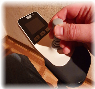
Beispiel eines Joysticks am Elektrorollstuhl
